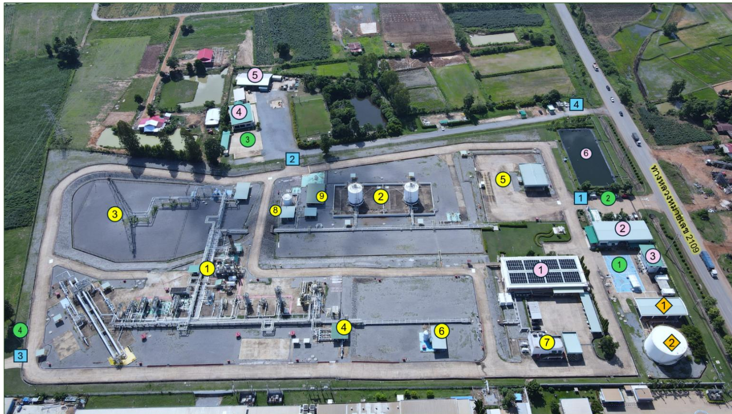
รูปที่ 2.2-8: องค์ประกอบภายในสถานีผลิตก๊าซธรรมชาติ (Gas Processing Plant หรือ GPP)
